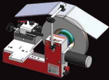
**INDY 420** – Maschine zum Bearbeiten von Bremsscheiben besteht aus: Konen und Distanztopf von 40mm bis 100mm mit 24v DC Antrieb, zwei Wendeschneidplatten, Bedienungsanleitung Handbuch und 12 Monaten Garantie.
